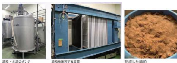
酒粕・水混合タンク 酒粕を圧搾する装置 熟成した酒粕
