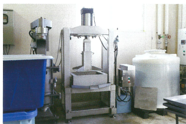
じっくりと炊き上げた栄養価たっぷりの豆をすり潰した後はさらに油圧プレス機で搾る。
