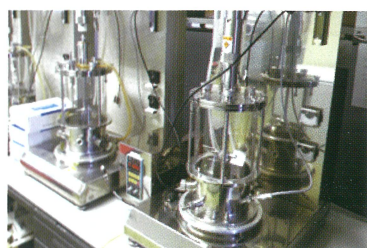
最適な発酵条件を探し出すための必須アイテム、小規模ジャーフェメンターシステムをトータル5配置。
