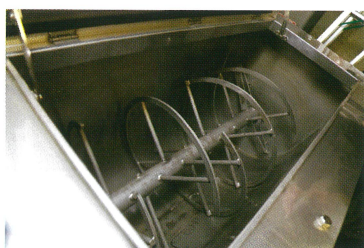
このスクリーが回りエゾシカの骨を粉砕、それ以外の部分はオガクズが分解する原理。
