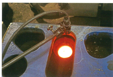
温度が10度違ってても完成品には影響が出る、赤外線温度計の導入で温度管理は万全の体制に。
