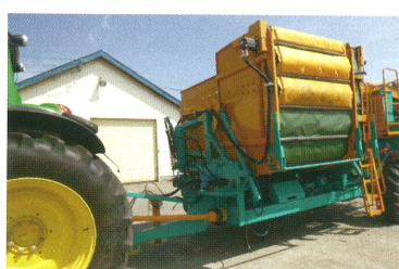
ISOBUSはトラクターと規格ケーブルを接続することで、システムが連動する「プラグアンドプレイ」での稼働が可能。
