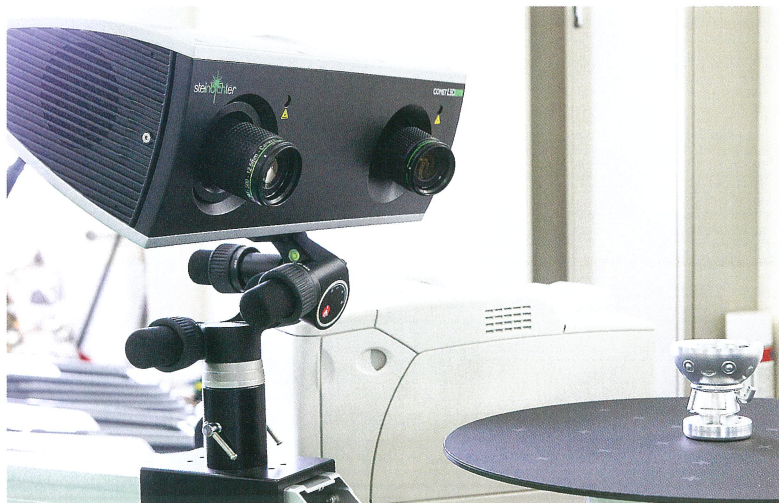
今回の事業で導入した非接触3次元測定システム。
