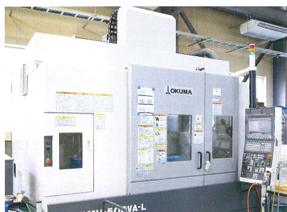
さらなる高速・高精度化に対応するために 導入した5軸制御立型複合加工機。
