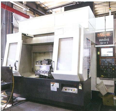
5軸加工機の導入で、複雑な形状の部品加工や、小ロット対応がしやすくなった。
