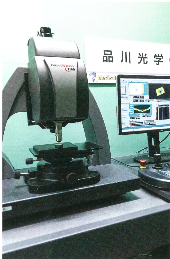
非接触球面形状測定器で誤差を定量的に測定。 品質確保及び製作期間の短縮が可能に。
