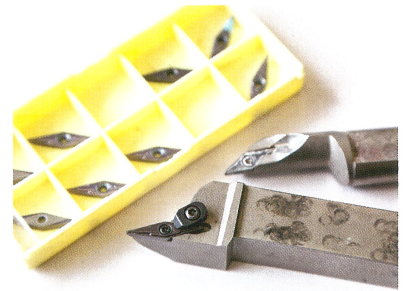
超精密切削加工を可能とするコバルト合金専用の バイト（刃）。
