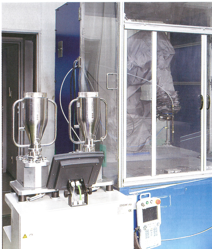
本事業で開発したコールドスプレー装置。 粉末供給装置以外は、コスト面で優れる国内産部品を採用。
