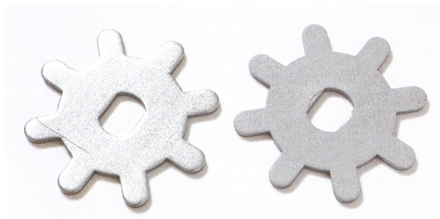
右が、ステンレス基材にコールドスプレー装置で高温耐食皮膜を施した部品。
