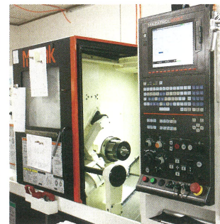
NC 自動旋盤では、高速回転で重切削が可能に。表面粗さ精度を確保することができる。
