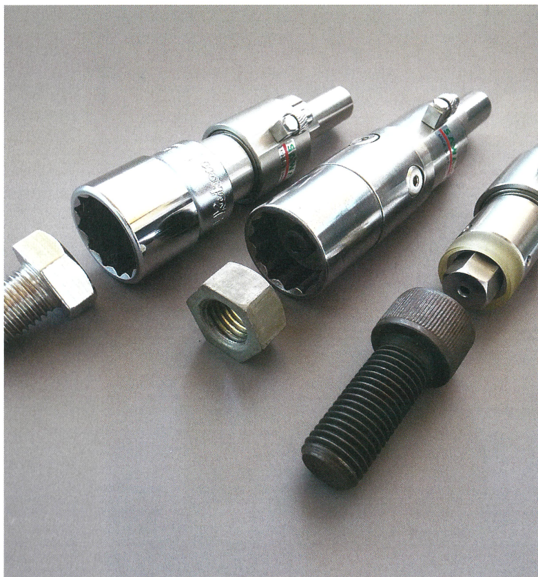
真空吸着方式によるネジ保持器。径2～16mm。 ボルト、ナット、キャップスクリューそれぞれに対応。
