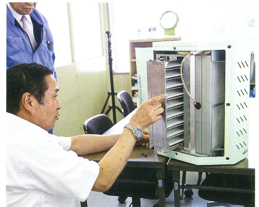
光触媒プレート部分をユニット型にすることでメンテナンスの簡易化・合理化が可能に。
