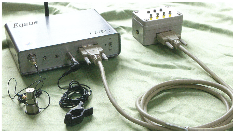
異常検出装置の試作 1 号機。ブザーと LED ランプの点滅、無線 LAN で異常を通知する。
