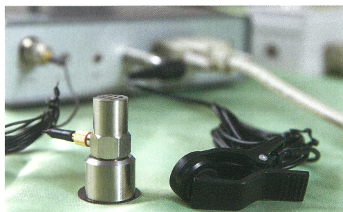
加速度型振動ピックアップと圧電型簡易マイクで異常を検知する。
