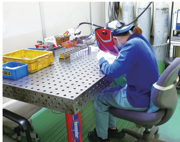
レーザーによる溶接加工の様子
