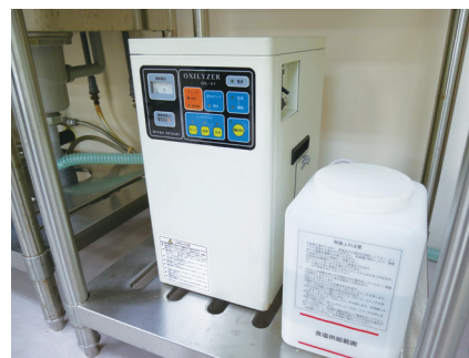
三浦電子が開発した強酸性電解水生成装置
