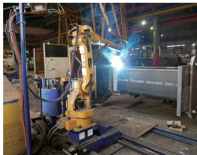
導入した溶接ロボットシステム
