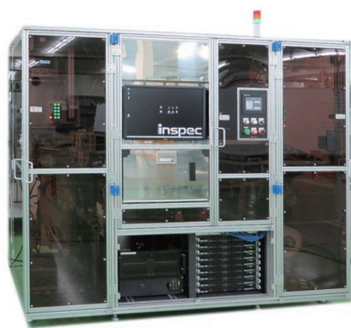
フレキシブル基板外観検査装置の例
