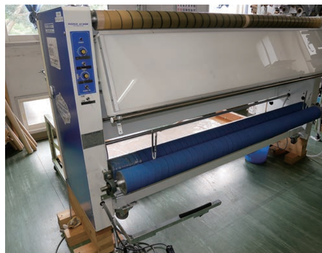
工員の身長に合わせ、高さを調整した検反縮絨機
