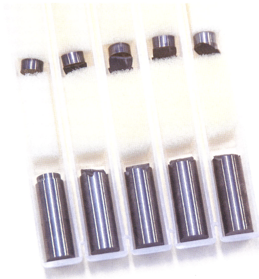
試作テスト ロウ付けの強度が高く、超硬ポディーの方が切断されてしまったものも
