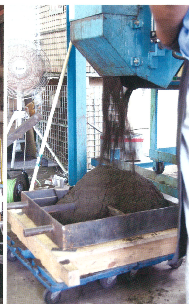
再生砂を用いた高強度鋳型の製作。
