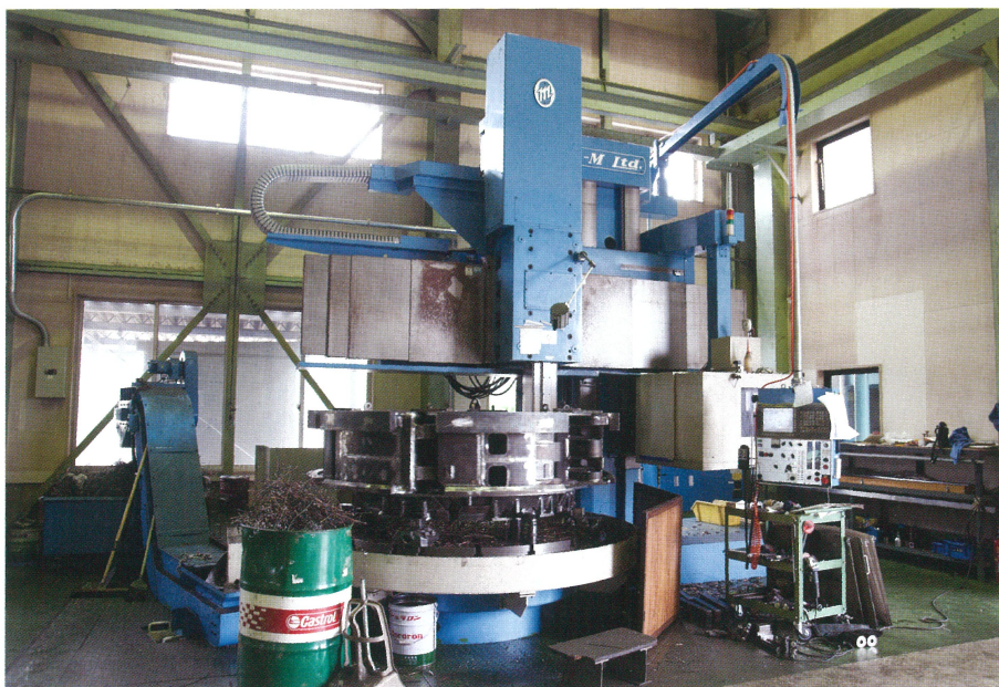
これまでより大型・高精度の加工に対応可能な、CNC制御立型旋盤。
