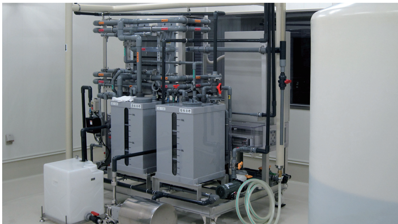
電気透析脱塩装置を導入
