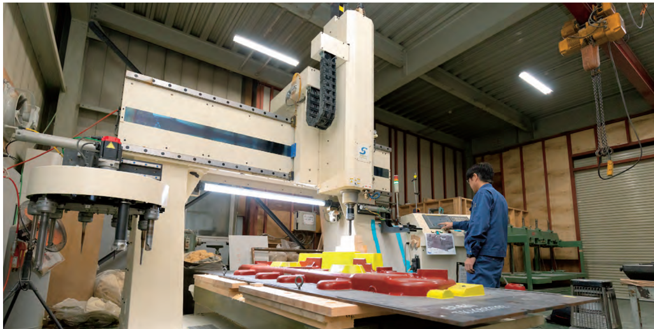
導入したNCモデリングマシンによる木型加工の様子
