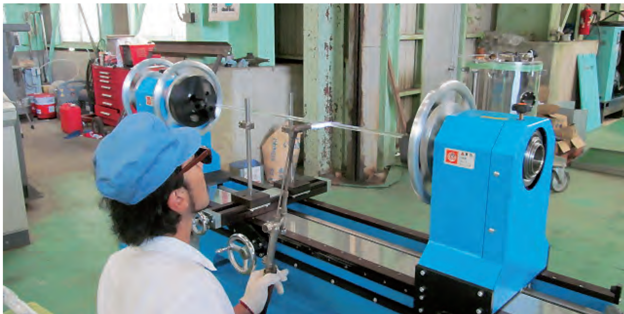
導入した測定器により開発した小型ガラス加工旋盤
