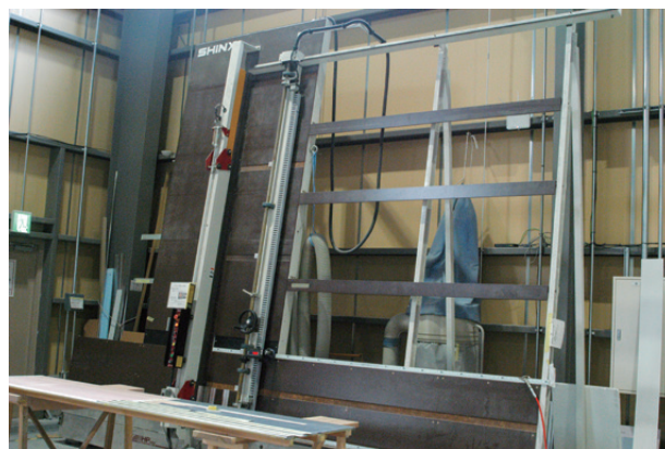
パネルソーを使って建材パネルを切断の様子。大きな素材にも対応できるようになった
