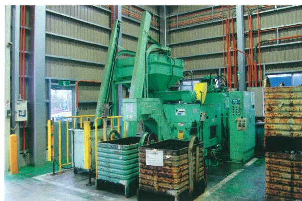
▲切粉を圧縮するブリケットマシン
