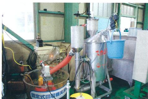
▲回収機で回収した浮遊物を、水分と分離するシステム
