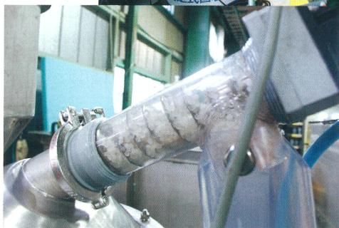
▲回収機で回収した浮遊物を、水分と分離するシステム
