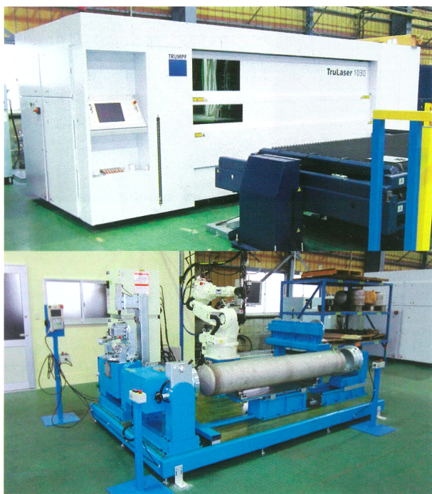
▲レーザー切断&ロボット溶接システムによって、給水タンクの鏡板部分の溶接や、その他部材の切断加工が可能になった
