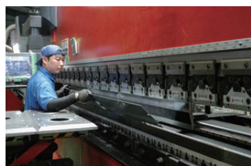
大型ベンダーの曲げ加工は適正で均一な加圧が大切。使用する曲げ金型などの選定も慎重に行なった
