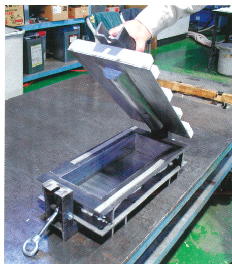
▲一体成形品製作のための金型。原液射出、硬化後に型から抜き出す
