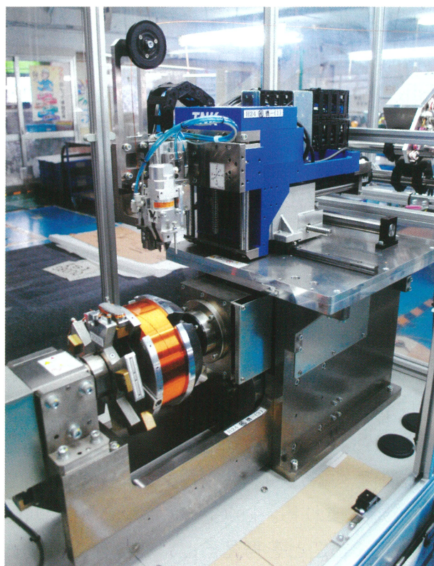
▲巻線層数20層以上を実現した、自動整列巻線機
