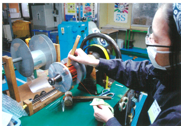
▲人の手でトラバース（送り）しながら整列に仕上げている。作業者の熟練の技が頼りである
