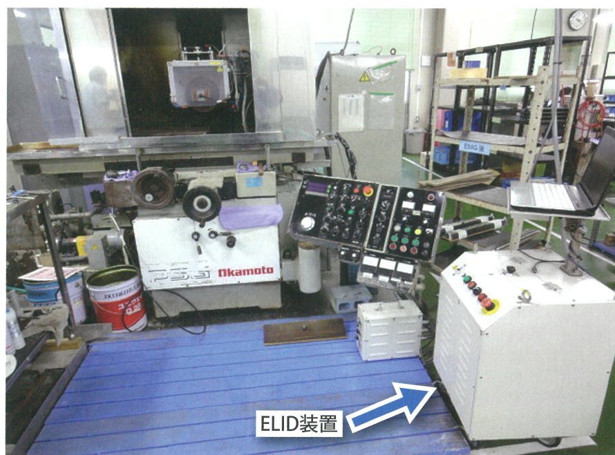
▲導入した注射針穴あけ加工用ELID装置
