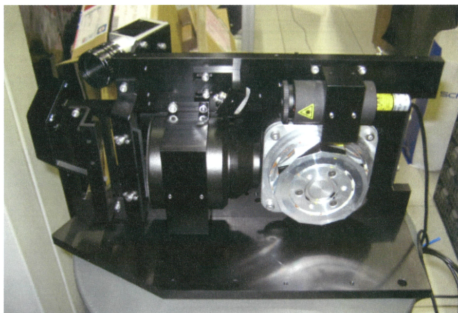
写真1:検査の大量化を実現したレーザー走査光学系
