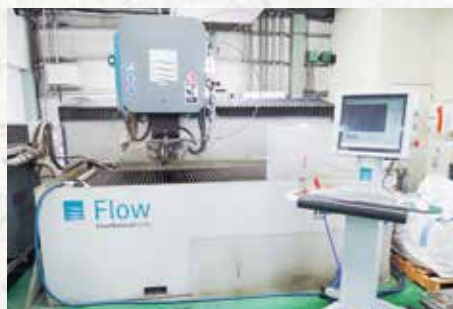
導入した Flow 社製のウォータージェットカッター
