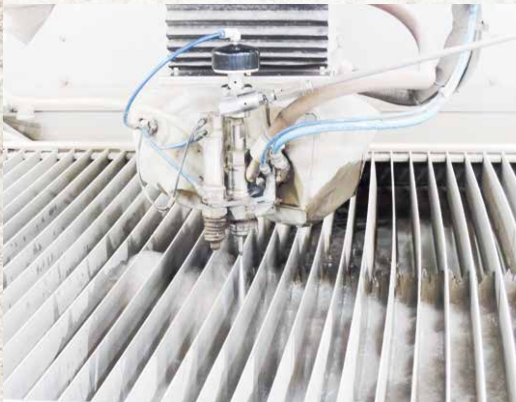
ウォータージェットカッターの改良型ノズル部のアップ
