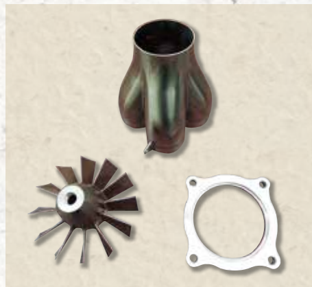
これまでに手がけた加工サンプル。 右下がウォータージェット加工した自動車部品
