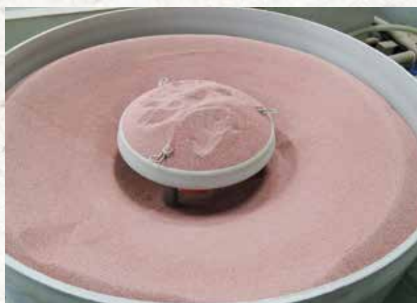
切削用の砥粒。加圧した水を混ぜて難削材を切削する
