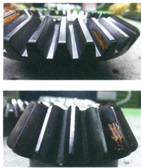
図9. 簡易かみ合い試験機による試験結果
