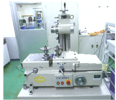
図10. 歯車かみ合い試験器 (大阪精密機械製 GTR25)
