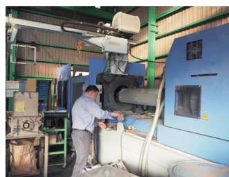
電動サーボ式射出成形機導入で不良率が低下
