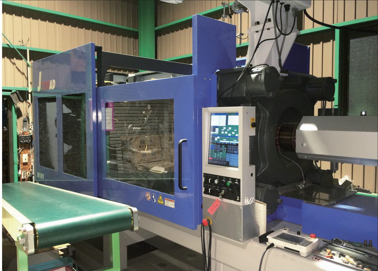
導入した電動サーボ式射出成形機は省エネ性能にも優れる
