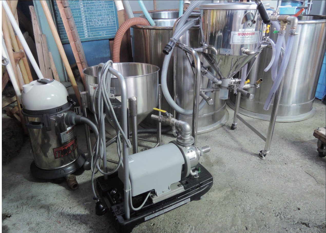
酒造用洗米機コメクリーンの洗米機（右）と吸引脱水機（左）。水流と泡で糠を落とし確実な洗米ができる
