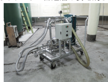
火入れ急速冷却機。 火入れ後に急速冷却し品質劣化を抑える
