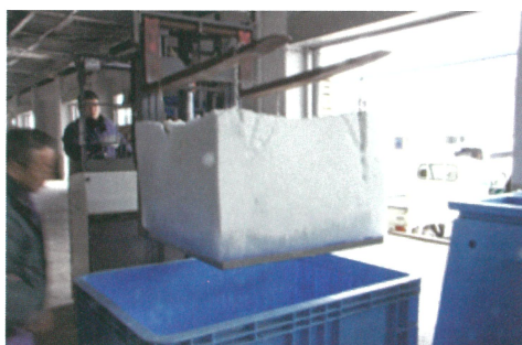
フォークリフトによる製氷装置からの脱氷
