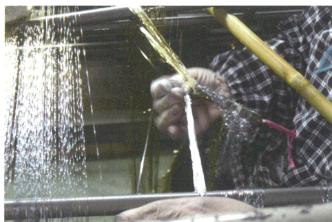
手つなぎによるフィルム扁平糸のタテ糸つなぎ
