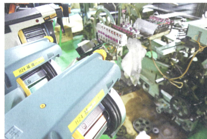
ヨコ糸に2色を使ったフィルム扁平糸の織物を製作
