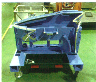
リサイクル化を実現したアルミ铸件製の検査治具
