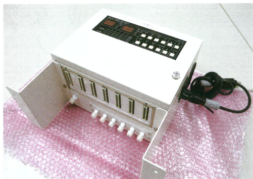
最大6地点の空气中オゾン濃度を測定できる測定器
