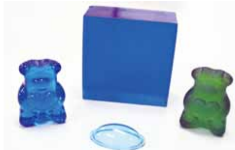
四角いアクリル樹脂のブロック(中央)とマイクロ波成形して作った熊のオブジェや医療用レンズの試作品
