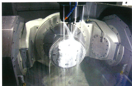
ブリス্ক（上）と、同時5軸加工の様子（下）
