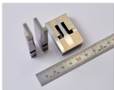
1μmの精度で仕上げる金型部品
