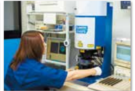
面精度を測定するレーザー干渉計
