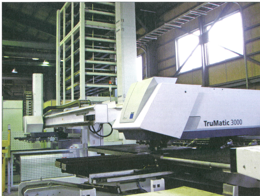
▲トルンプ社製 パンチレーザー複合機
