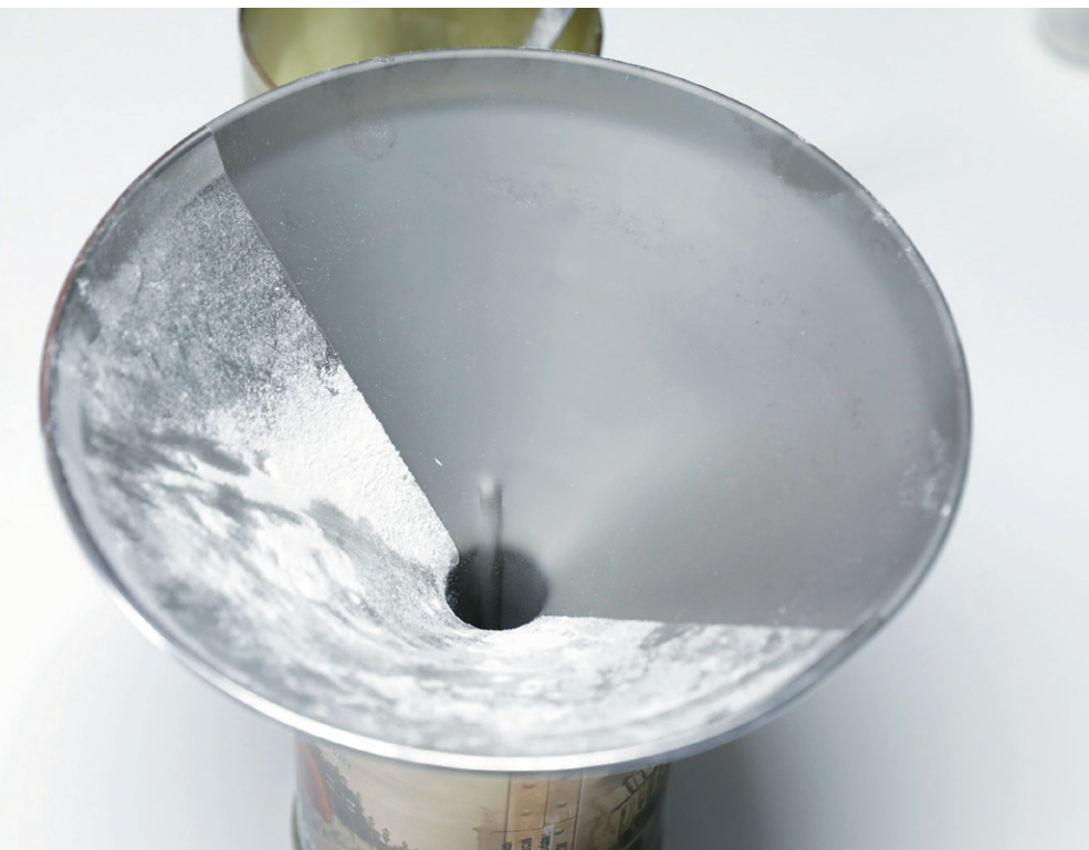
▲WPC処理により摺動性(すべり良さ)を高めた漏斗(右側)。左側は鏡面加工
