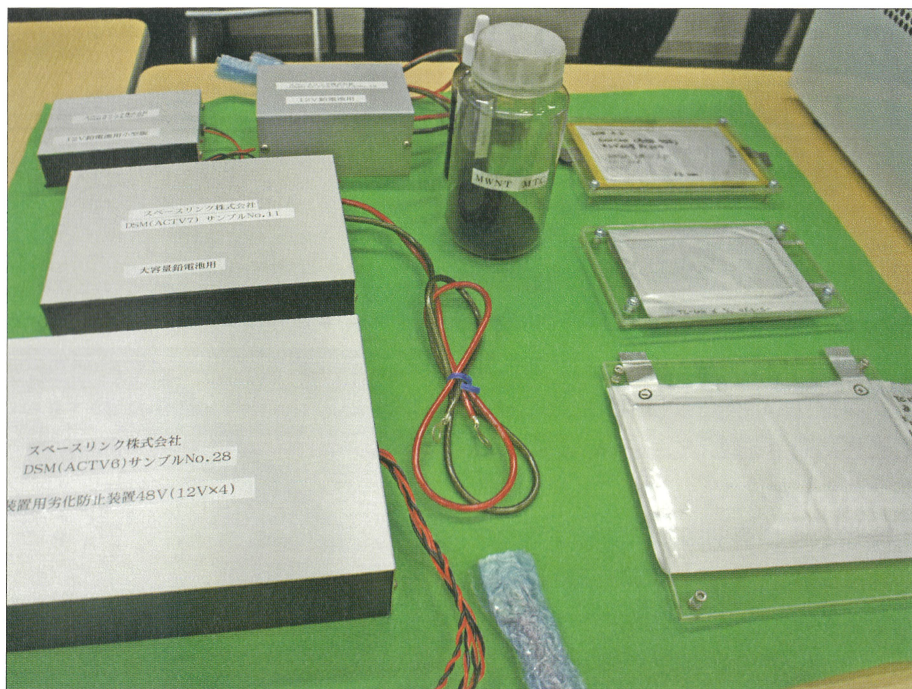
▲ CNT キャパシタ（右）とそれを組み込んだ蓄電池製品（左）
