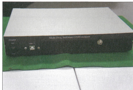
▲4周波同時受信が可能なマルチ GNSS 受信機
