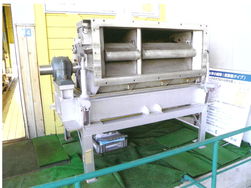
70kwクロスフロー水車
