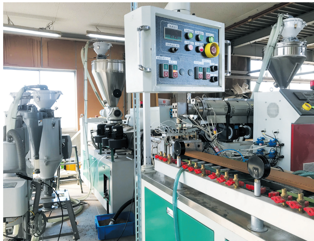
二層式人工木材の押出成型機
